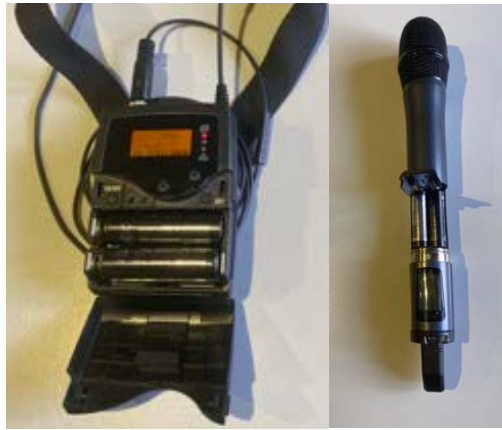
Abb. 8: Zum Wechseln der Akkus: Umhängemikrofon aufklappen, Handmikrofon unten aufschrauben
