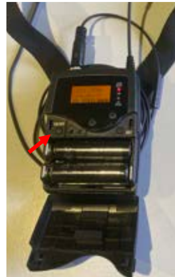
Abb. 4: Zum Einschalten ON/OFF-Taste lange drücken
