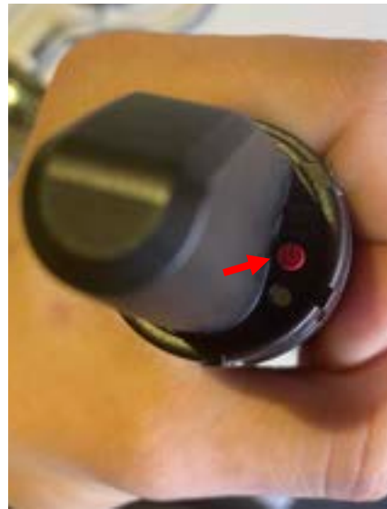
Abb. 3: Zum Einschalten ON/OFF-Taste lange drücken
